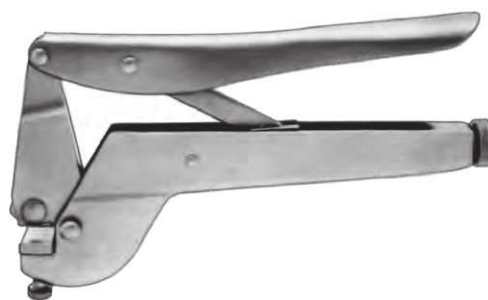
Kleszcze do gięcia płytek prostych o grubości do 3,2 mm
