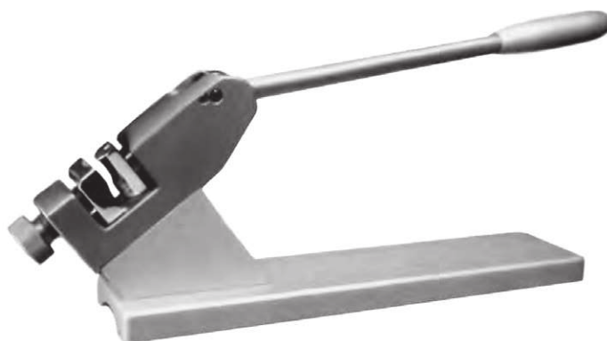
Prasa do gięcia płytek prostych i kątowych o grubości do 6 mm
