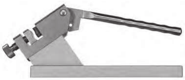
Prasa do gięcia płytek prostych i kątowych o grubości do 3,2 mm
