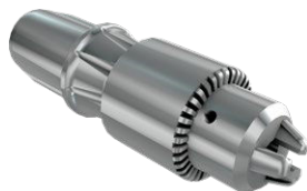
Rys.2. Obsada uchwytu wiertarskiego z maksymalnie rozwartymi szczękami, które należy poddać uważnemu czyszczeniu
