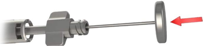
Для выталкивания оставшегося в канюле цемента (1,2 мл) необходимо использовать толкатель [40.8596.000]. Вставьте толкатель в отверстие канюли и толкните пока ручка толкателя не упрется в канюль.
