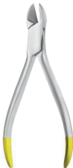
40.7250 140 mm max Ø 1,5 mm drut miękki soft wire мягкая проволока max Ø 1 mm drut twardy hard wire твердая проволока utwardzane ostrza hardened edges упрочненные лезвия
