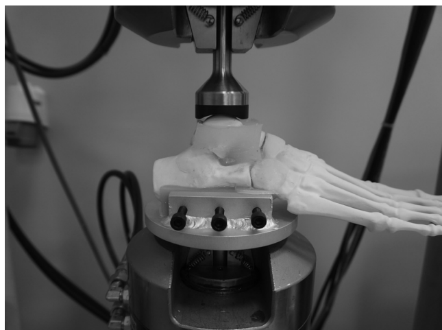
Ryc. 5. Model stopy podczas badań dynamicznych Fig. 5. Foot model during dynamic loading testing
