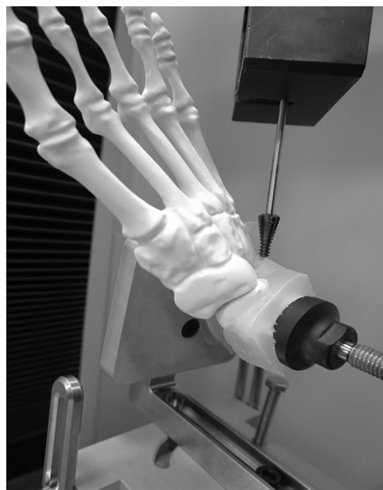
Ryc. 7. Model stopy podczas badania siły wyrywania Fig. 7. Foot model during pull-out force testing
